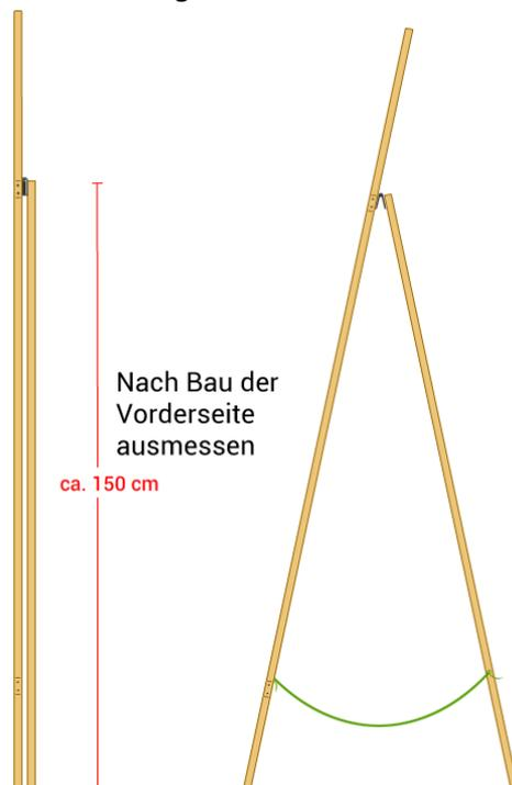
Das hintere Bein wird mit einem Scharnier an der Vorderseite angebracht (mittig obere Querleiste)
